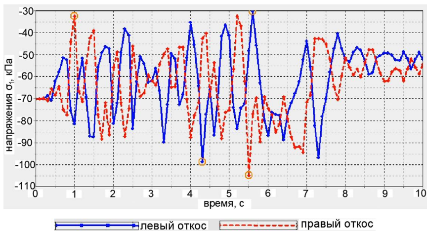
Рис. 9. Зависимость напряжений от времени по акселерограмме в точках формирования поверхности скольжения для недемпфированного ж.-д. земполотна
