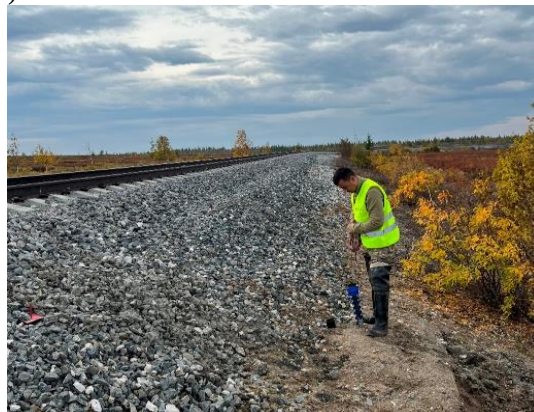
Рис. 2. Процесс измерения температур грунтов основания в ходе проведения геокриологического мониторинга участка железной дороги на 167 км перегона Чум – Лабытнанги: а – в холодный период года; б – в теплый период года
