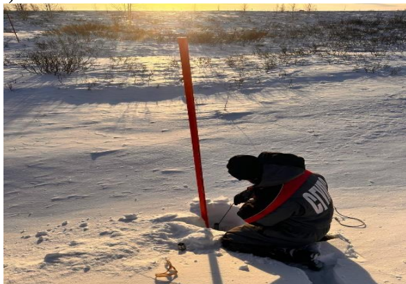
Рис. 2. Процесс измерения температур грунтов основания в ходе проведения геокриологического мониторинга участка железной дороги на 167 км перегона Чум – Лабытнанги: а – в холодный период года; б – в теплый период года
