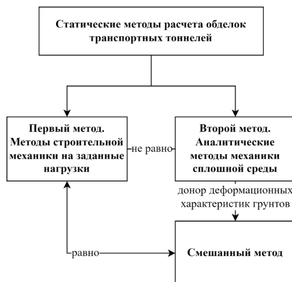
Рис. 2. Смешанный метод расчета тоннельных обделок
