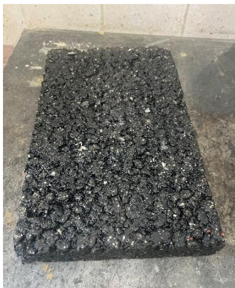
Рис. 1. Изготовленный контрольный образец-плита
