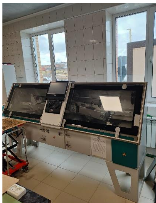
Рис. 2. Вид установки для испытания прокатыванием нагруженного колеса
