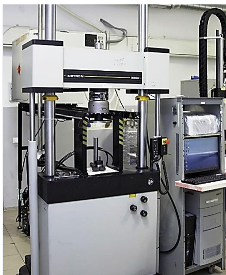
Рис. 3. Сервогидравлический пресс INSTRON 8802
