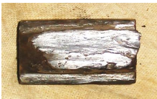
Рис. 4. Кулачок клинового зажима, изношенный от проскальзывания по стержню
