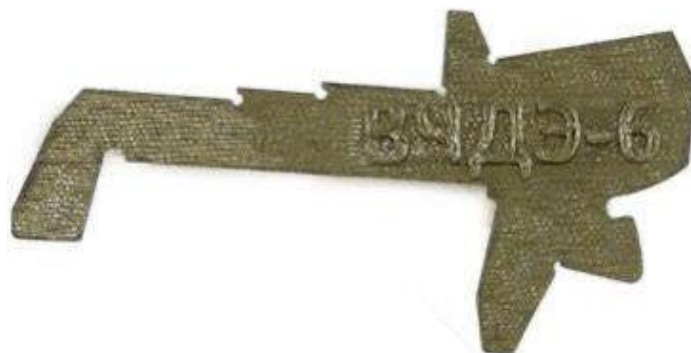
Рис. 2. Шаблон 873, выполненный на 3D-принтере
