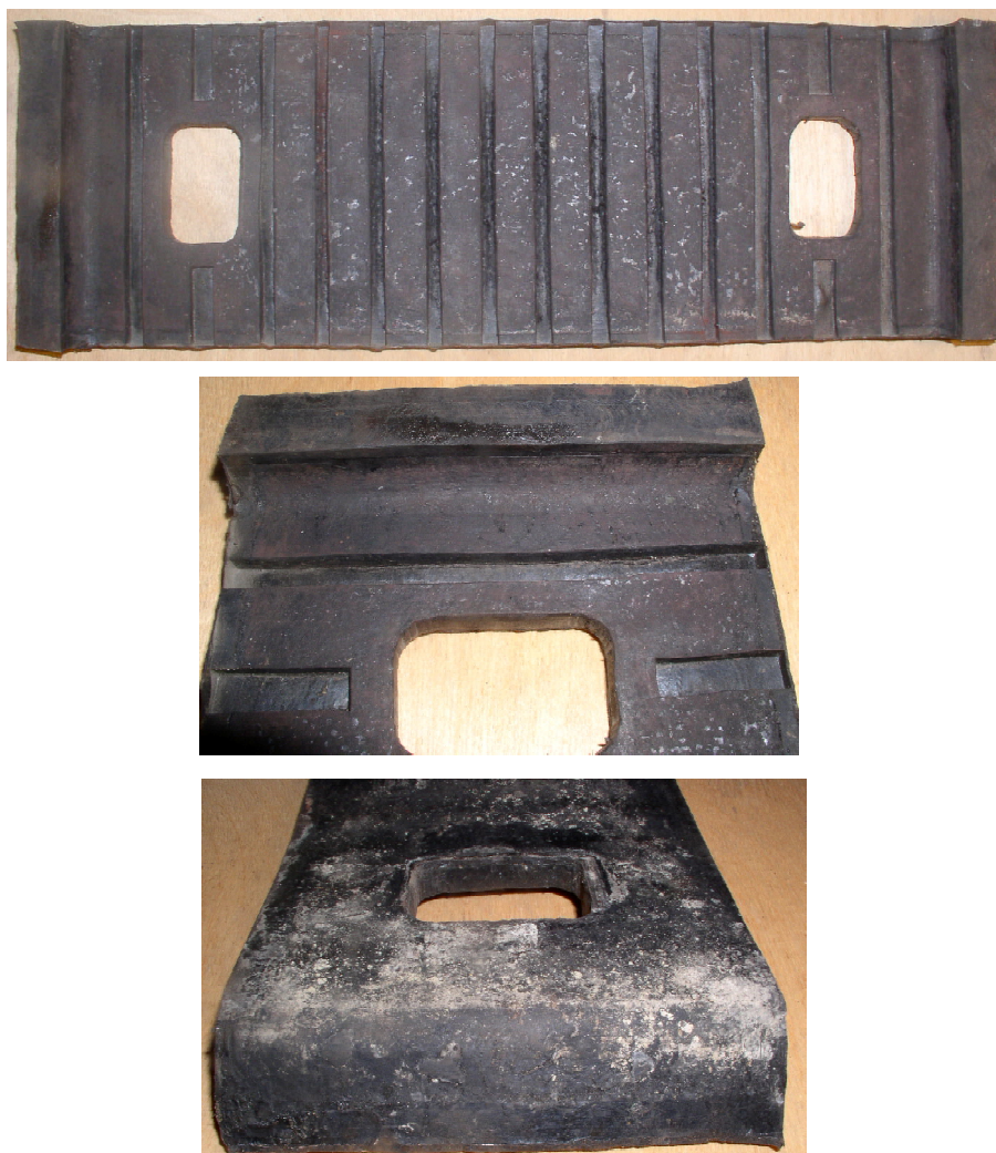
Рис. 6. Вид напильной прокладки ОП-318 и ее буртика с рабочей стороны после испытаний в узле КН-65
