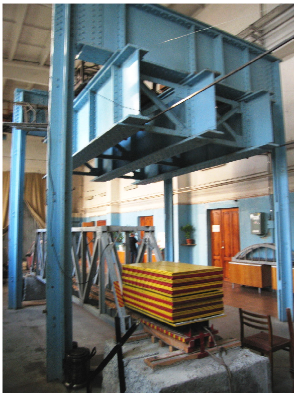
Рис. 2. Силовой стенд с моделью металлического пролетного строения
