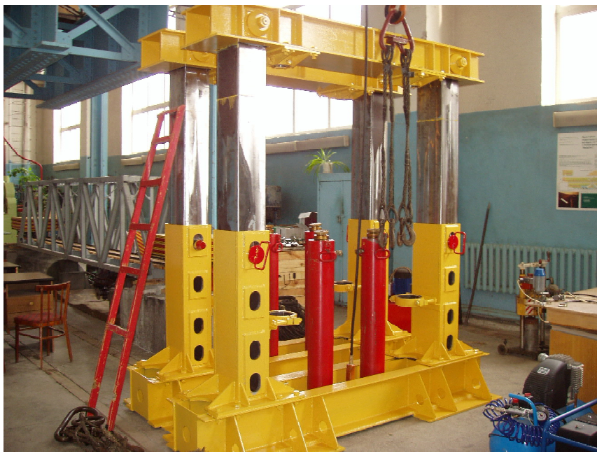
Рис. 4. Технологический комплекс для подъёмки железобетонных пролетных строений железнодорожных мостов
