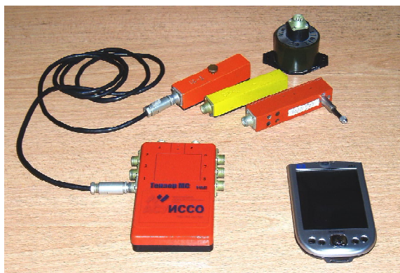
Рис. 3. Автоматизированный измерительный комплекс «Тензор МС»
