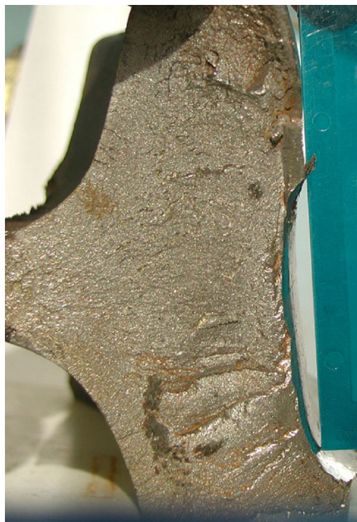
Рис. 15. Износ поверхности катания колес: а — левого; б — правого
