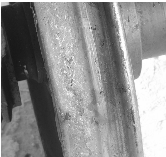
Рис. 15. Износ поверхности катания колес: а — левого; б — правого
