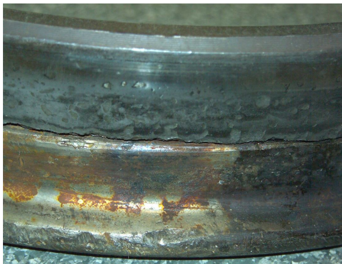
Рис. 8. Выкрашивание поверхности бандажа вдоль образующей
