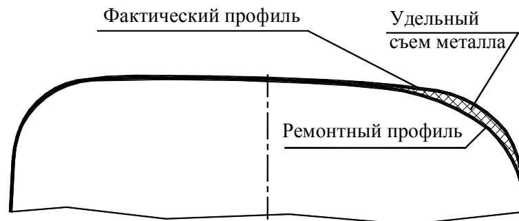
Рис. 1. Наложение ремонтного профиля рельса на фактический поперечный профиль рельса
