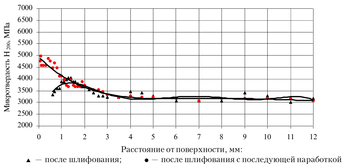
Рис. 4. Микротвердость и структура металла поверхностного слоя головки рельса: а — микротвердость головки рельса до и после шлифования; б — структура металла головки рельса до шлифования; в — структура металла головки рельса после шлифования; г — микротвердость головки рельса после шлифования и с последующей наработкой
