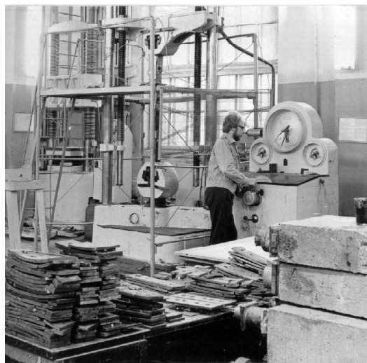
Испытание стальных элементов старых мостов на выносливость
