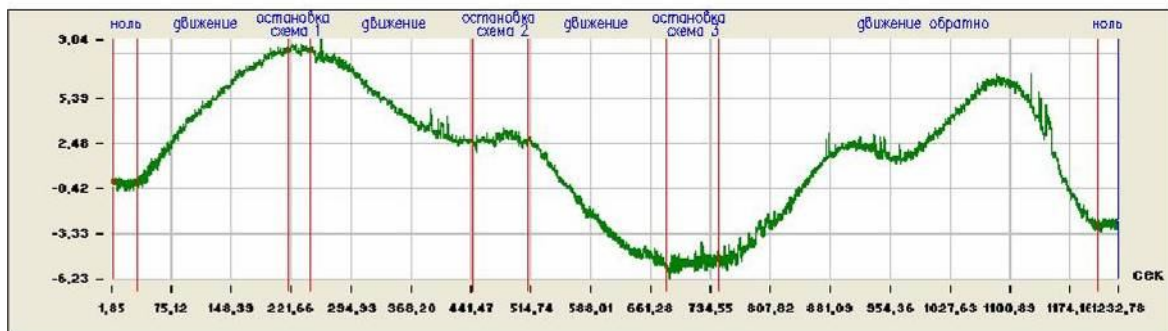
Рис. 7. График перемещения подвижной ОЧ на опоре 10 ПС 10–11–12
