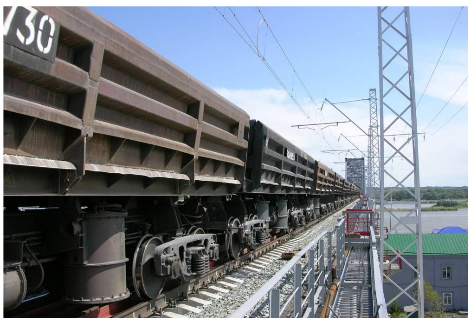
Рис. 3. Заезд испытательной нагрузки на мост со стороны левого берега
