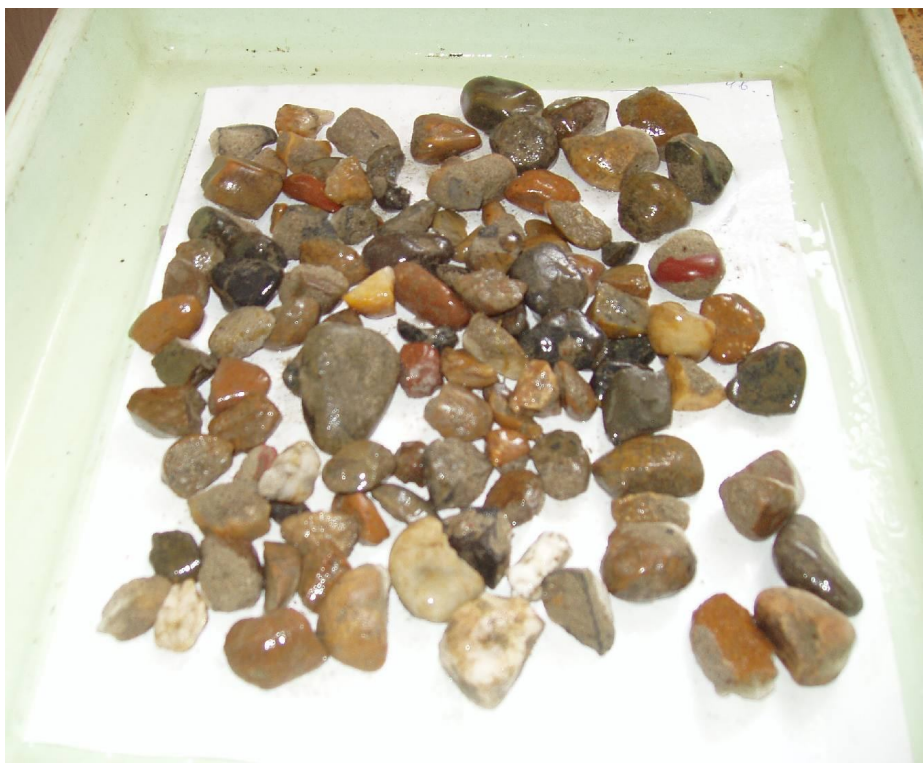
Рис. 11. Образцы гравия (речного галечника) из бетона ядра заполнения опоры № 3
