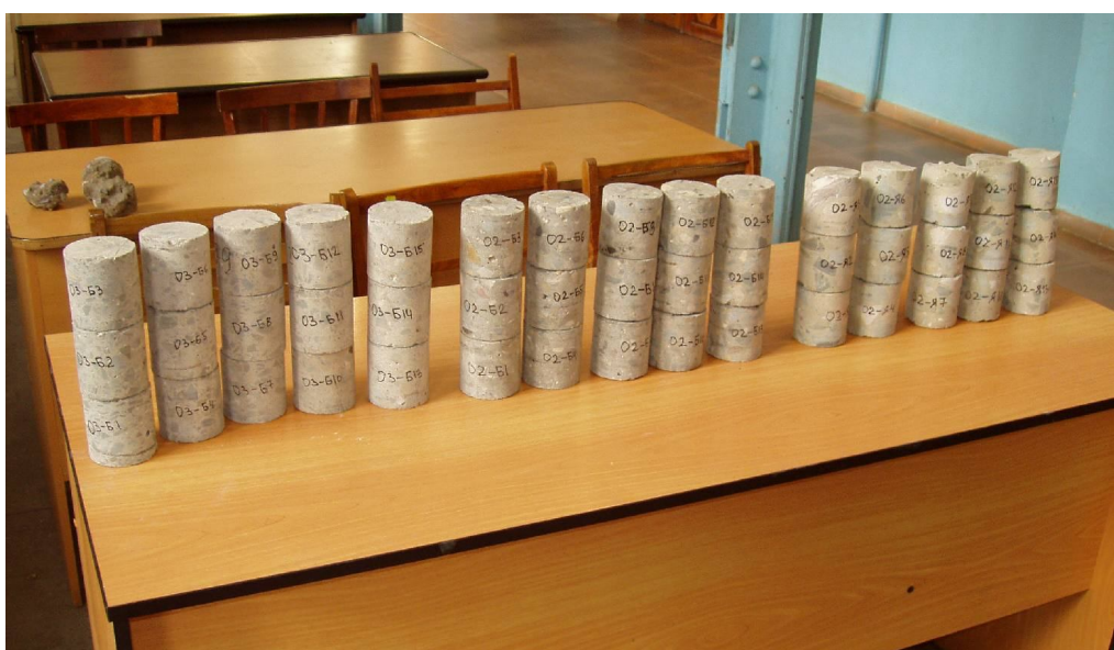
Рис. 9. Образцы бетона на испытания
