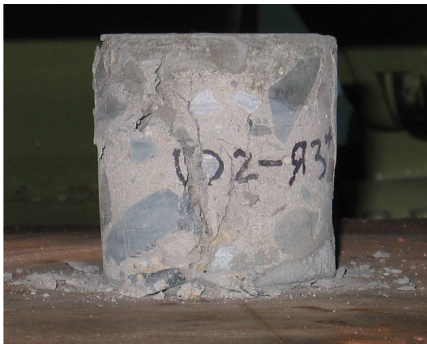
Рис. 10. Образец бетона ядра заполнения после испытания на прочность
