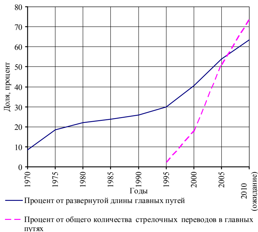
Рис. 1. Протяжение главных путей на железобетонных шпалах и количество стрелочных переводов на железобетонных брусках
