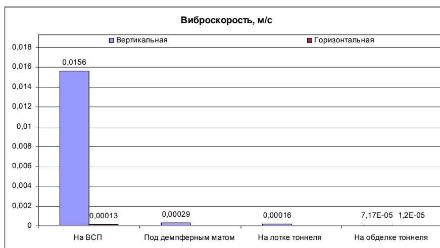
Рис. 21. Гистограммы виброскоростей в исследуемом сечении тоннеля
