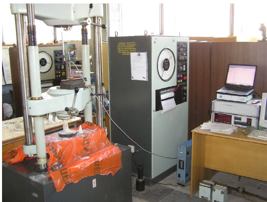
Рис. 5. Стенд для испытания кернов известняка на одноосное сжатие
