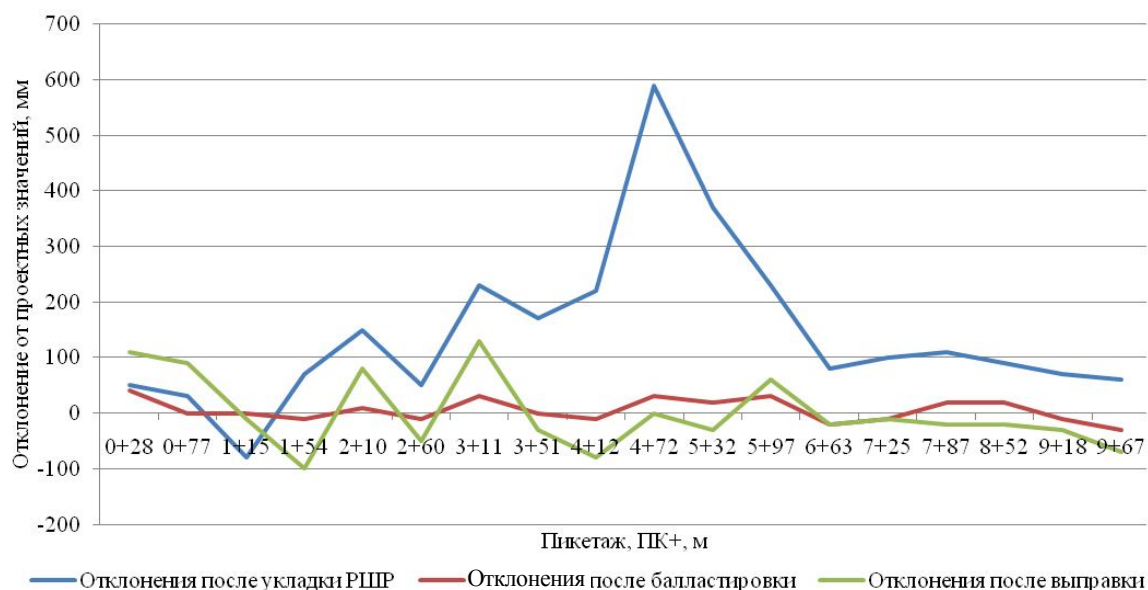
Рис. 1. Отклонения габаритных расстояний от проектных решений на однопутном участке
