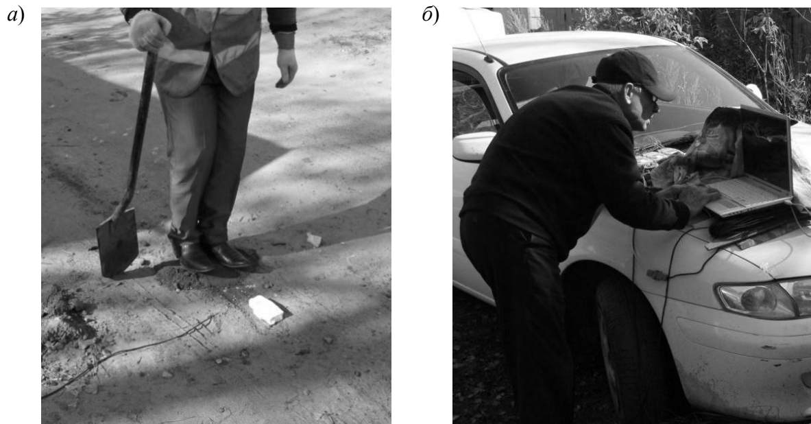
Рис. 2. Установка меток над месдозой (а) и момент замера напряжений от движущегося транспорта (б)
