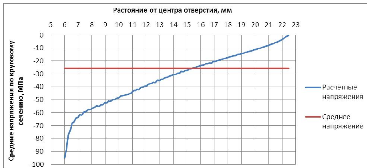
Рис. 6. График распределения нормальных напряжений по контактной поверхности на стеклопластиковом листе при толщине шайбы 5,5 мм
