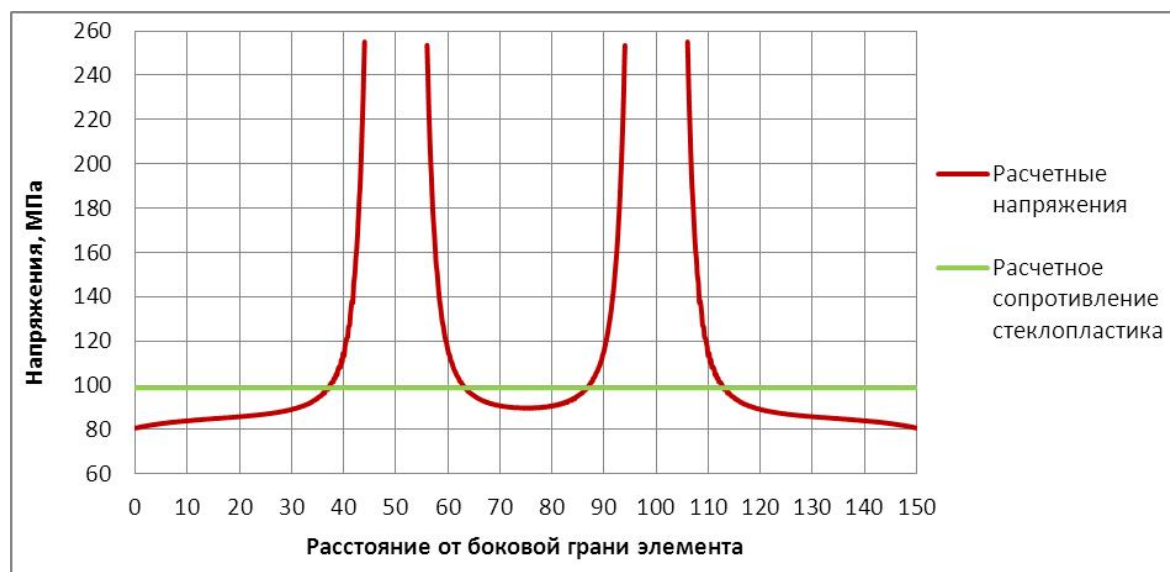
Рис. 5. Эпюра нормальных напряжений в расчетном сечении
