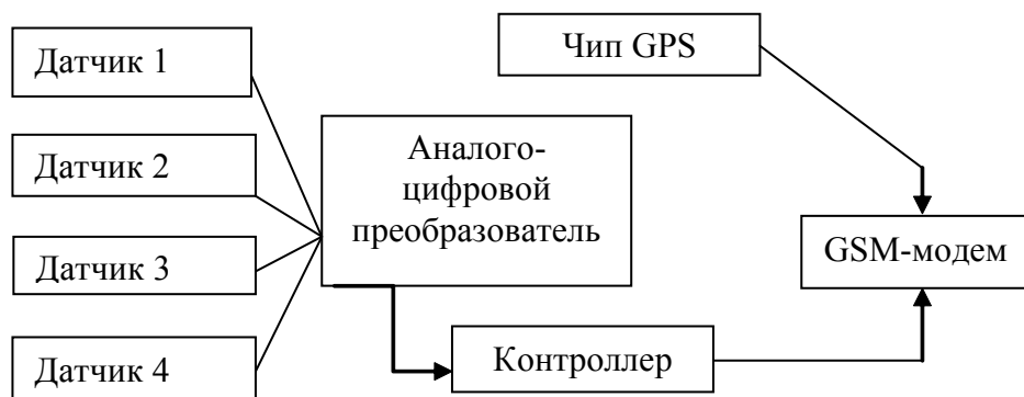
Рис. 4. Бортовое оборудование СДМД
