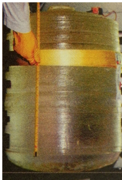
Рис. 2. Монокристалл NaI(Tl) диаметром 440 мм, выращенный на установке «РОСТ»
