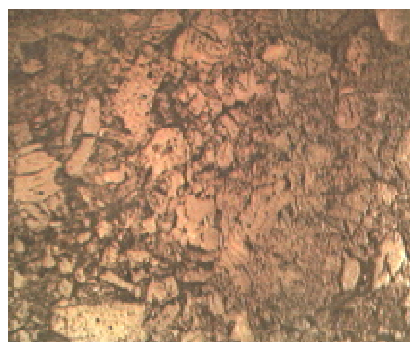
Рис. 1. Микроструктура образцов огнеупора: а – экспериментального; б – импортного
