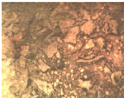
Рис. 1. Микроструктура образцов огнеупора: а – экспериментального; б – импортного
