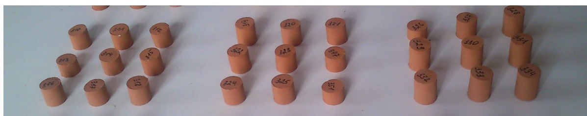
Рис. 3. Керамические образцы на основе камышенского суглинка с добавкой осадка водоподготовки
