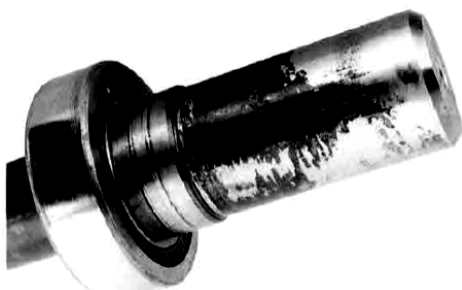
Рис. 2. Вал гидромашин, подверженный фреттинг-коррозии
