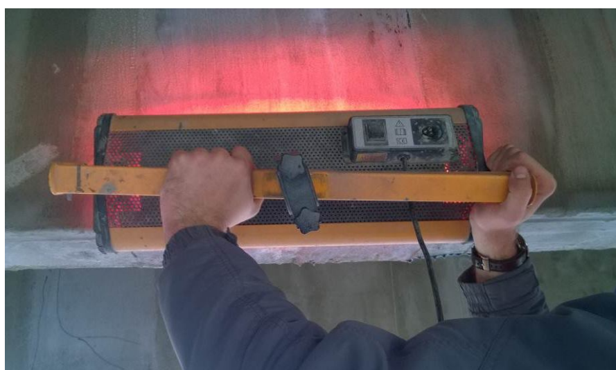
Рис. 3. Подготовка поверхности при активной термографии
