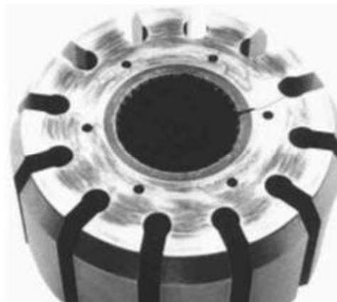
Рис. 4. Последствия превышения градиента давления: а – трещина на роторе; б – кавитационный износ торцевой поверхности ротора
