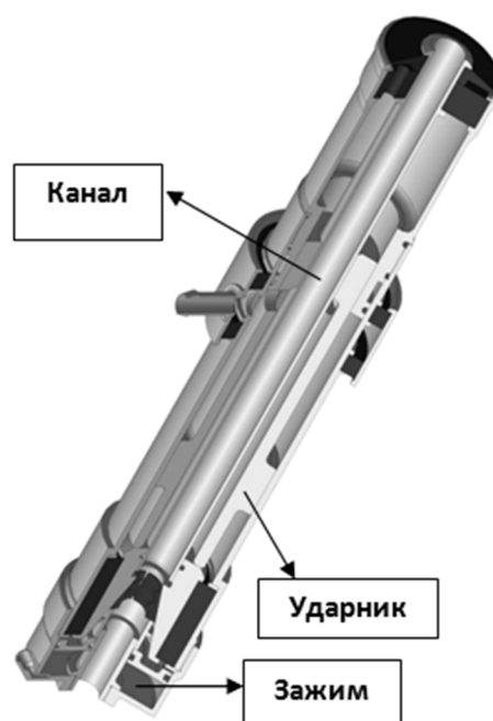
Рис. 1. Конструктивная схема пневмударной машины со сквозным осевым каналом
