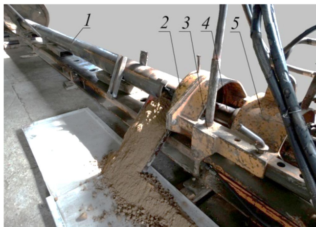
Рис. 4. Конструкция тягово-вращательного привода бурового станка:
