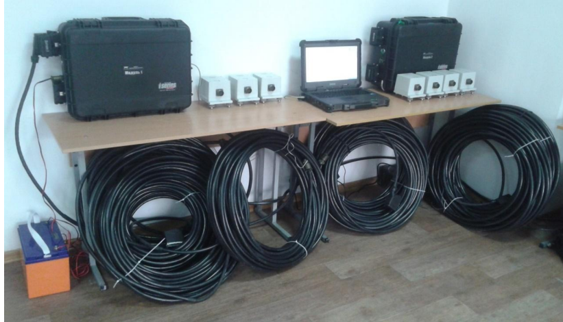
Рис. 1. Измерительно-вычислительный комплекс для динамических испытаний конструкций искусственных сооружений
