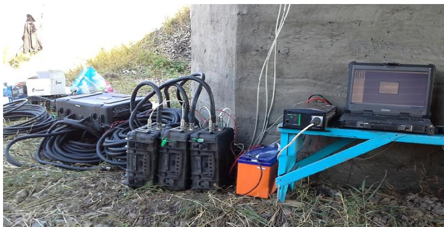
Рис. 3. Мобильный виброизмерительный комплекс в рабочем состоянии
