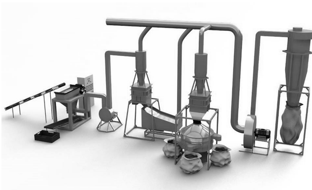
Рис. 4. Общий вид комплекса по переработке РТИ в резиновую крошку
