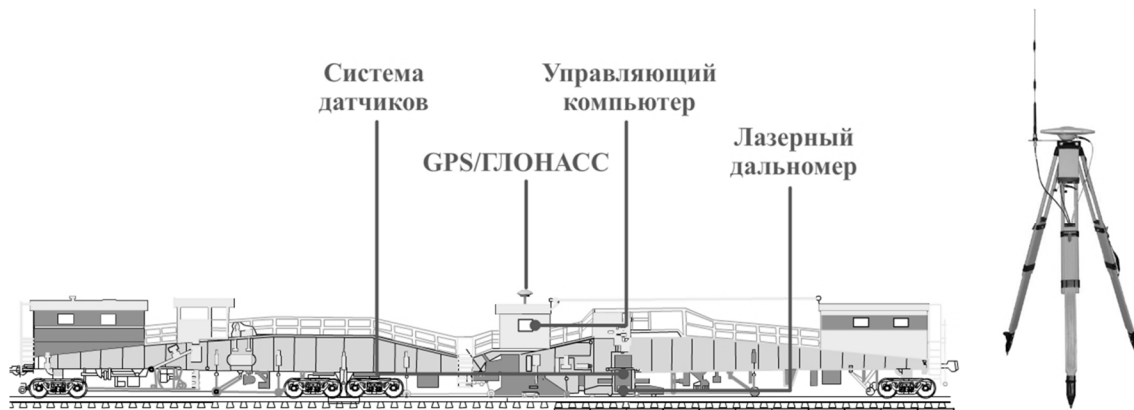
Рис. 1. Схема работы САУ постановкой пути в проектное положение на машине ЭЛБ
