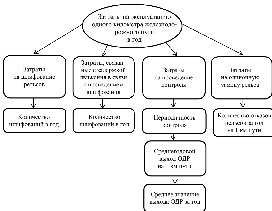
Рис. 2. Блок-схема затрат на эксплуатацию 1 км рельсов в год
