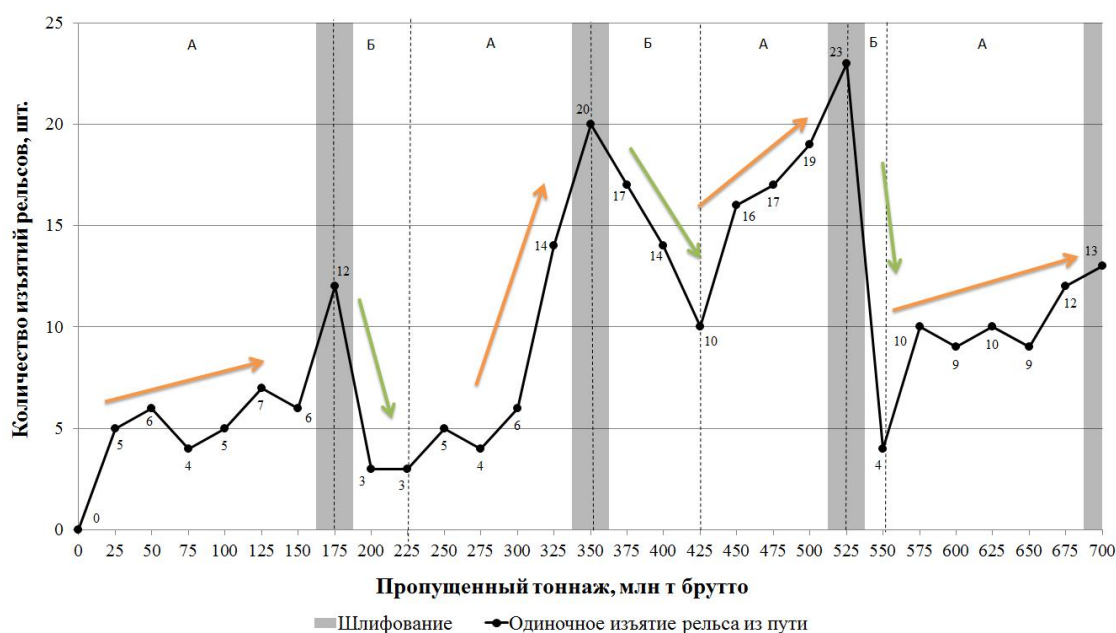
Рис. 3. Одиночное изъятие рельсов по причине появления дефекта 22.1.2/21.1.2
