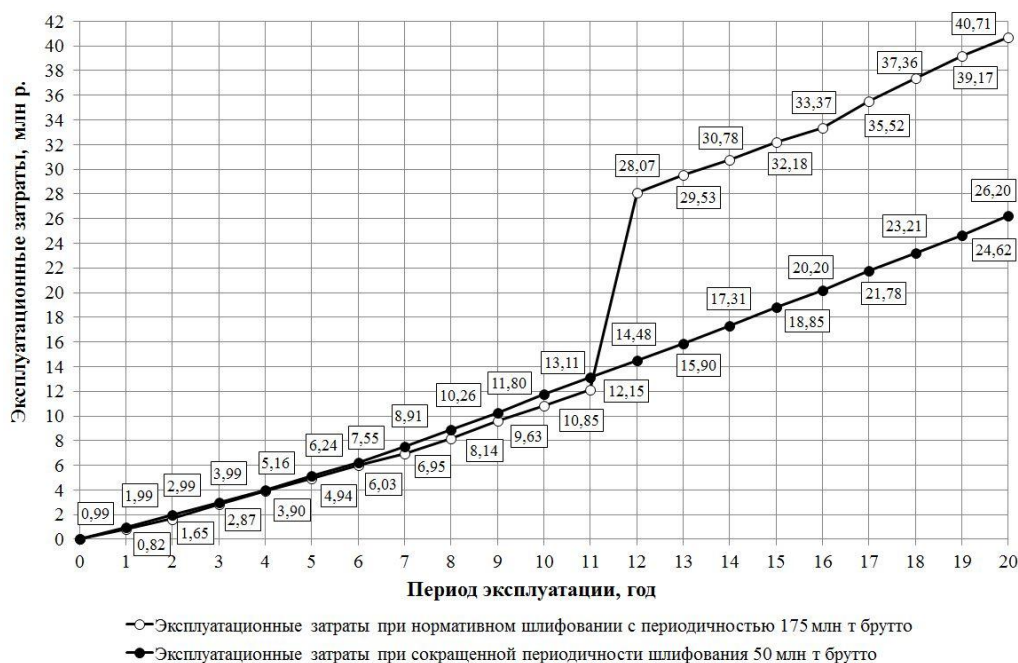
Рис. 5. Сравнительные эксплуатационные затраты при различной периодичности технологических воздействий
