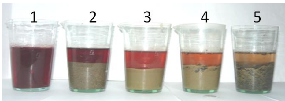
Рис. 8. Интенсивность адсорбции метилового красителя: 1 – метиленовый красный; 2 – песок кварцевый; 3 – глина; 4 – 50 % глины, 50 % осадка; 5 – осадок (в сухом состоянии)
