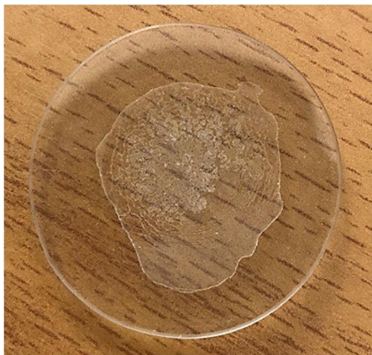
Рис. 10. Налет, образующийся после сушки фильтрата осадка при температуре 110^\circ\text{C}
