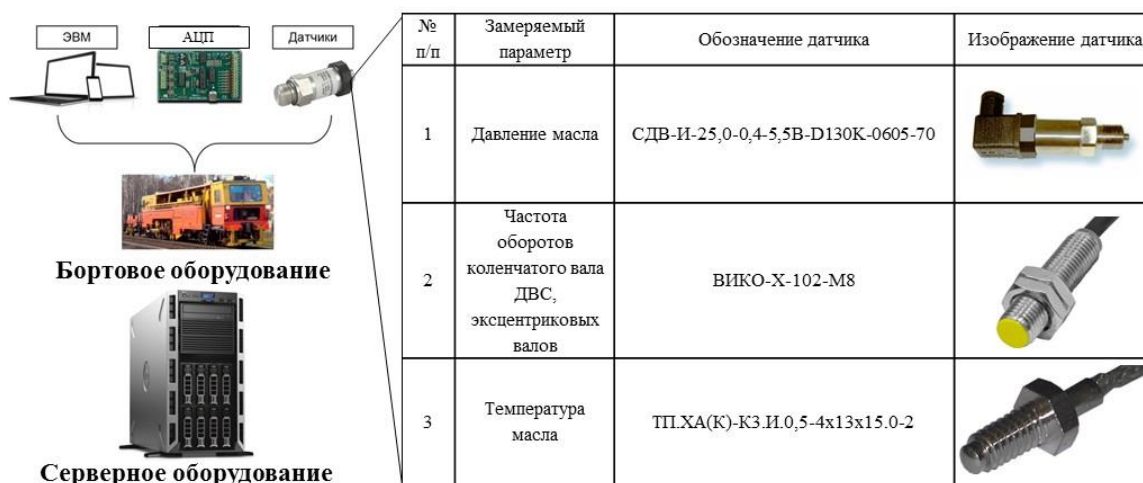
Рис. 2. Элементы СМТС, установленной на Duomatic 09-32 № 19
