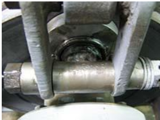
Рис. 3. Тормозная колодка с вращением фрикционной поверхности (а) и тормозной блок с вращением колодки (б)
