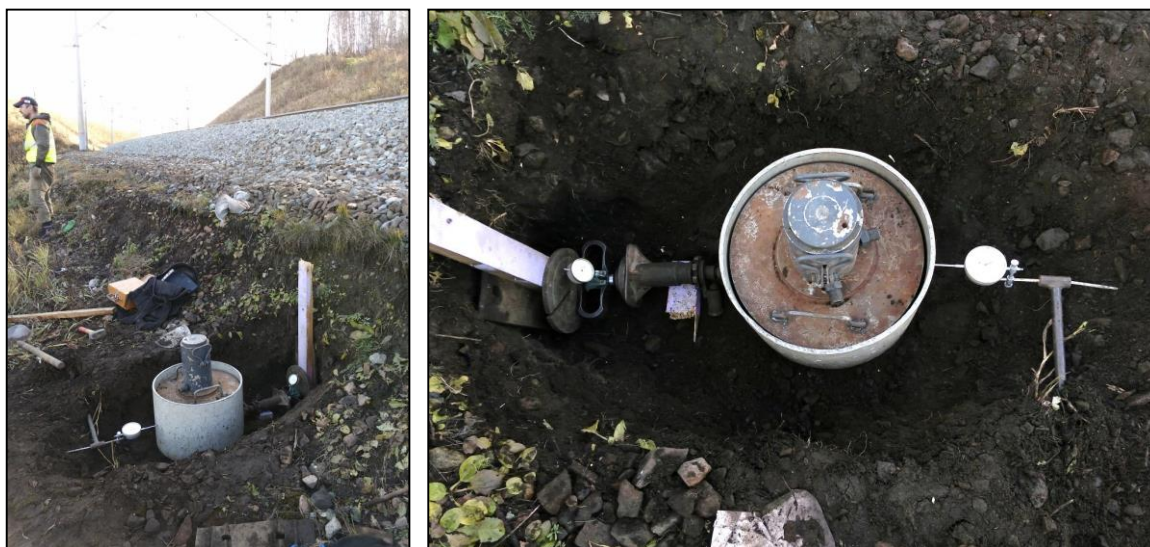
Рис. 3. Испытание балластных шлейфов срезом целиков
