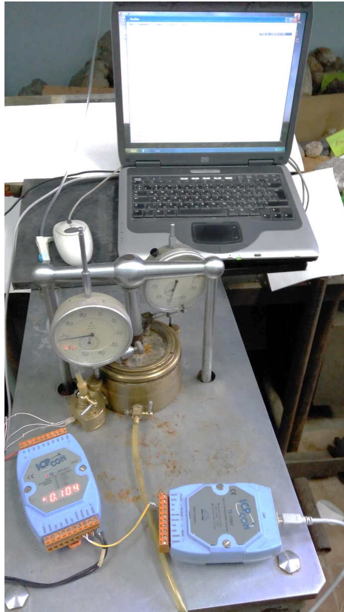
Рис. 3. Процесс проведения компрессионных испытаний с замером порового давления в образце грунта
