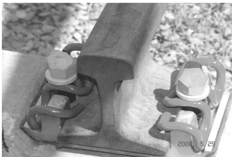
Рис. 9. Промежуточное рельсовое крепление KZF-07M
