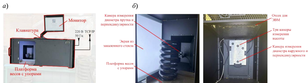
Рис. 2. Внешний вид (а) и устройство (б) автоматизированной системы измерения геометрических параметров пружин рессорного подвешивания
