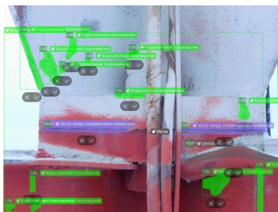
Рис. 2. Разработка компании Neimaker «Structure» с нейросетевым модулем [23]
