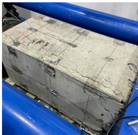
Рис. 8. Фотографии опорного стакана ОС-19 (а) и испытательной железобетонной призмы (б) после испытаний
