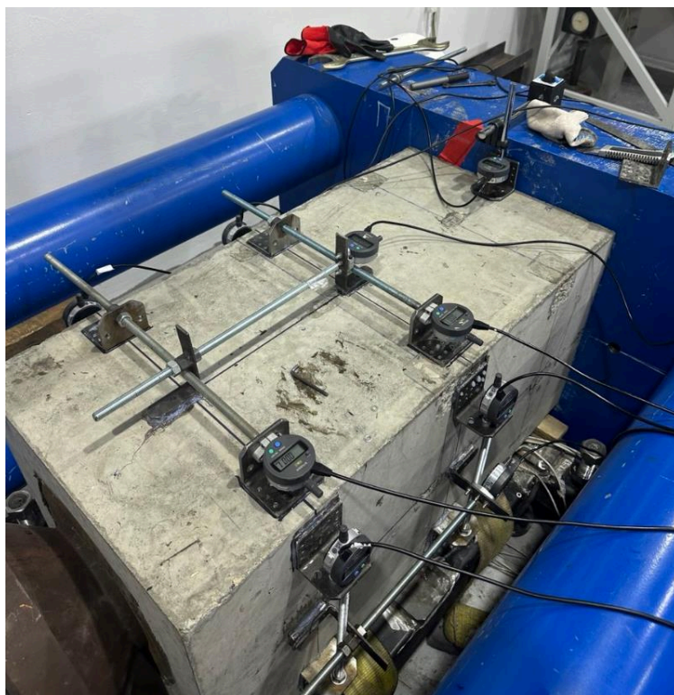
Рис. 6. Смонтированные индикаторы часового типа на трех гранях призмы
