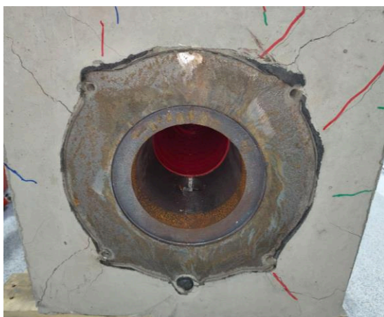
Рис. 8. Фотографии опорного стакана ОС-19 (а) и испытательной железобетонной призмы (б) после испытаний
