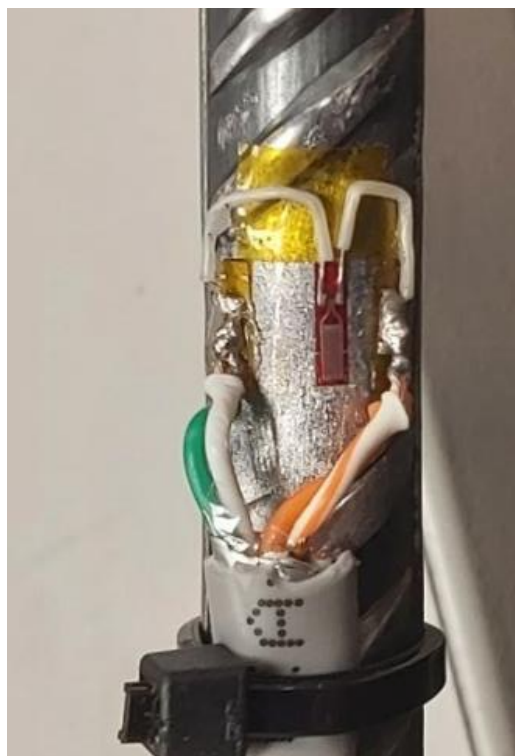
Рис. 3. Процесс испытания арматурного стержня (а) с наклеенным тензодатчиком (б)
