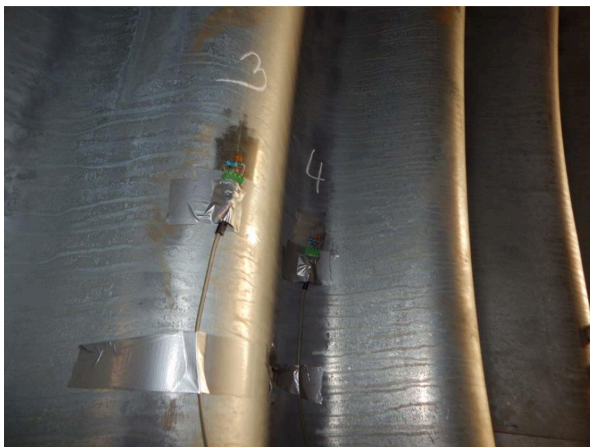
Рис. 4. Крепление тензорезисторов к поверхности гофрированного листа
