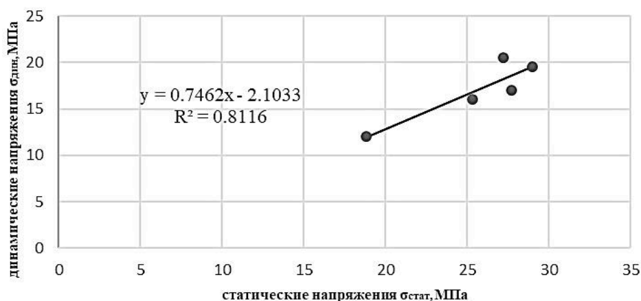
Рис. 8. Зависимость динамических напряжений от статических
