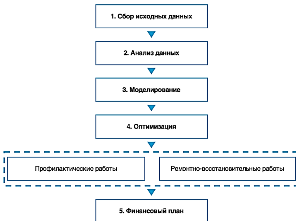
Рис. 1. Поэтапный алгоритм планирования затрат на содержание мостов
