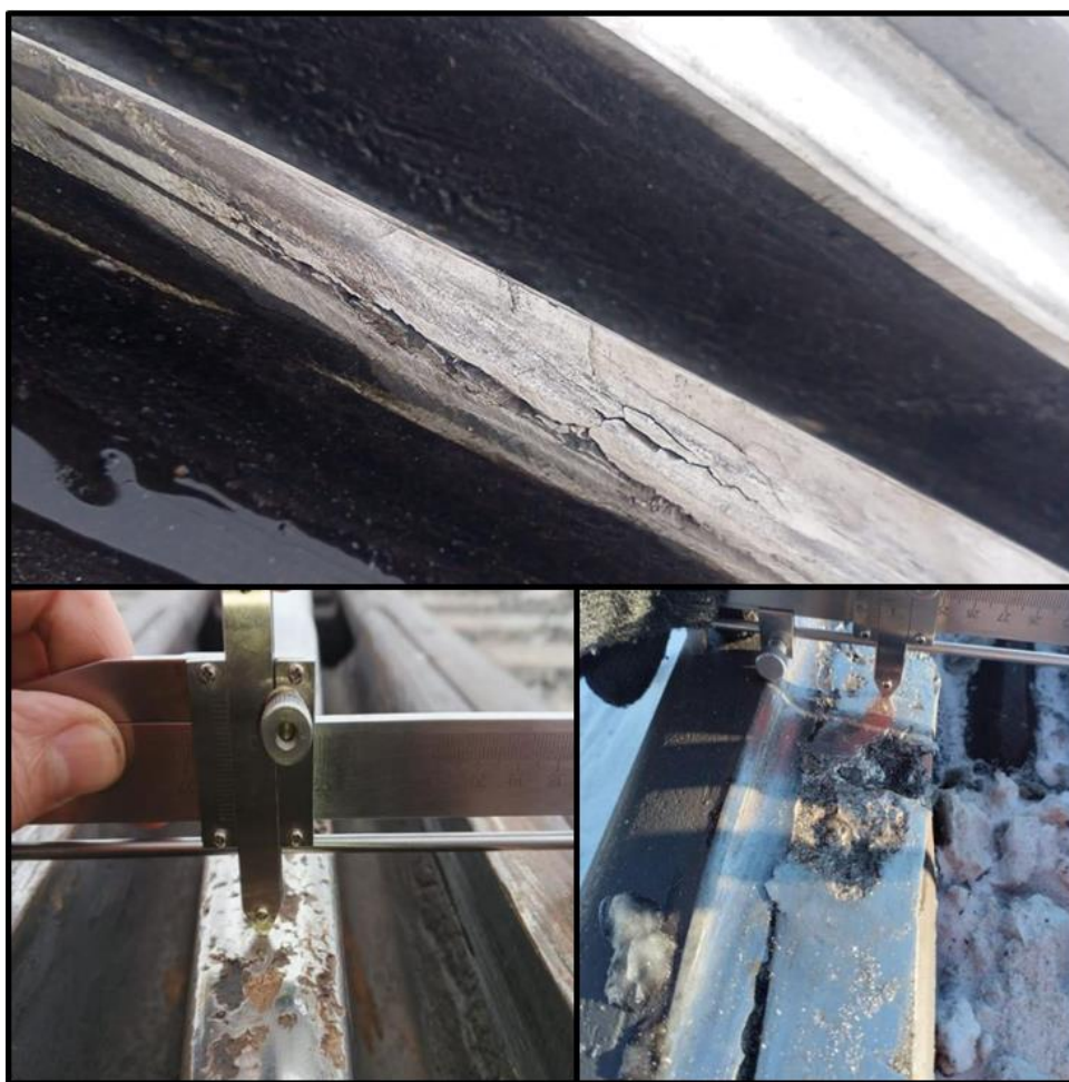
Рис. 4. Примеры выкрашивания сердечника и усовика крестовины
