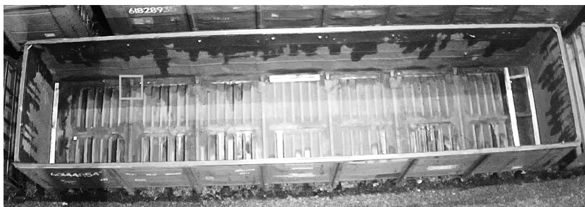
Рис. 3. Пример фотоизображения с пометкой отсутствия резиновой подкладки на месте ее укладки
